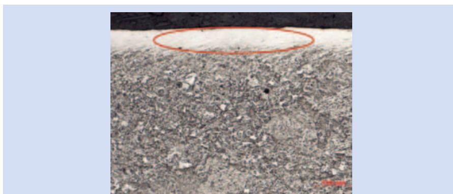
FIGURE 5 : Surface nanostructurée après NanoPeening®.
