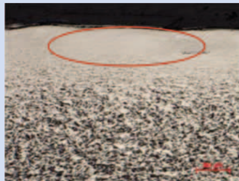
FIGURE 3 : Surface nanostructurée après NanoPeening®.
